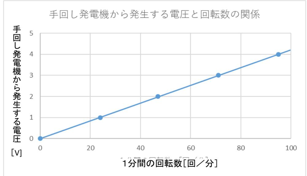
① 図Aのように、手回し発電機に直流電圧計をつないで、1分間の回転数を変えて電圧を測定しました。その結果、グラフBのようになりました。手回し発電機から発生する電圧と1分間の回転数の関係を何といいますか。15秒以内で教えてください。
